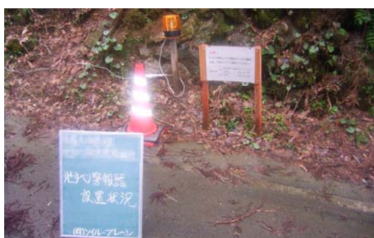
写真-1 起点側パトライト
